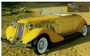
**В 1930 годах изящная модель** компании Auburn, автомобиль 851 Speedster, стал истинным украшением американских дорог. Его создатели пошли уже проложенной дорогой, отчасти повторив модель Mercedes SSK 1920-х годов, оборудовав машину восьмицилиндровым двигателем с турбонаддувом, что гарантировало ей скорость, превышающую 160 км/ч
