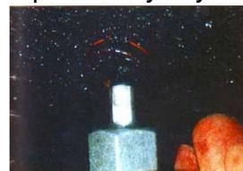
Для того, чтобы отвернуть сливную пробку картера, нужен квадратный торцевой ключ.
