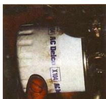
Масляный фильтр расположен перед блоком двигателя. Чтобы его снять, нужен цепной ключ, так как фильтр сильно затянут. Нанесите немного свежего масла на прокладку, а новый фильтр затягивайте только вручную.
