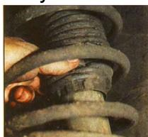
Тщательно проверьте состояние передних и задних амортизаторов. Убедитесь, что из-под защитных гофрированных чехлов не подтекает масло.
