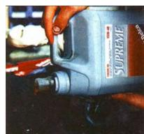
Залейте пять литров масла и, после минуты 4. работы двигателя, проверьте наличие утечек вокруг масляного фильтра и картера. Затем выставьте машину горизонтально и проверьте щупом уровень масла еще раз.
